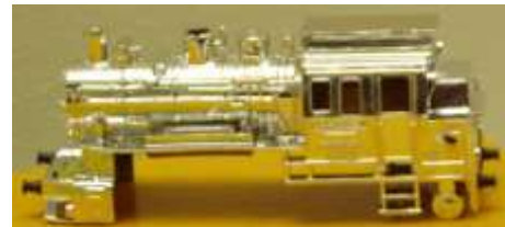
Verchromtes Gehäuse einer BR 89 zu Werbezwecken produziert. Dem Kunststoff wurde Kupfer beigemischt, der ihn leitfähig machte
