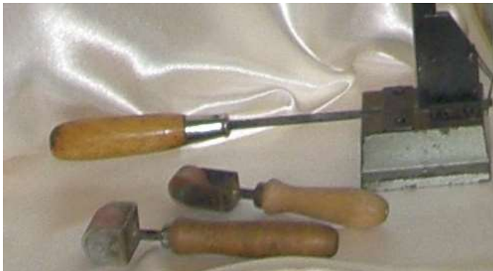
Montagewerkzeug für Kleinteile, Farbroller zur Beschriftung
