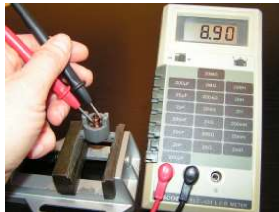
Messung der Ankerwicklungen beim Rundmotor
