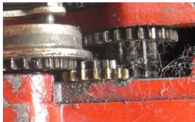
Stark verschmutzte Lauffläche und Zahnräder einer 01027
