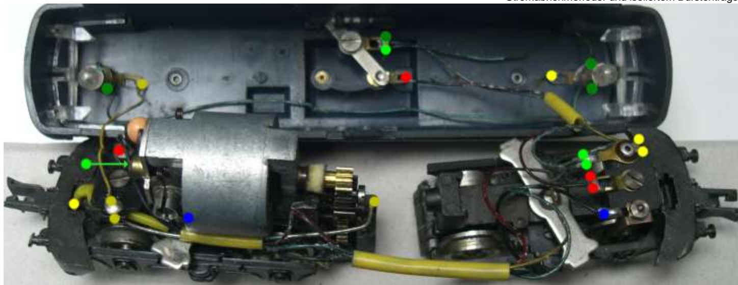
Rückseite des Motordrehgestells mit isolierter Stromabnehmerfeder und isoliertem Bürstenträger
