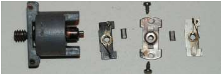
Die Einzelteile eines ROKAL-Rundmotors UPM-3
