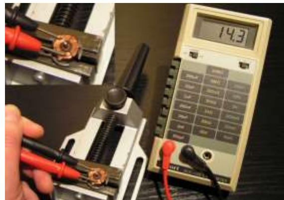
Messung der Ankerwicklungen beim Einheitsmotor
